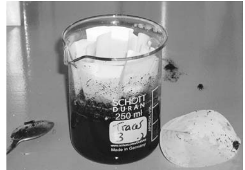
Foto | Vorbereitung zur Nitratbestimmung.
